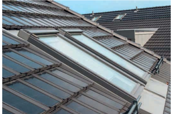
PAN 29 im Einsatz, zwei Mehrfamilienhäuser in Vich: 671 Module, verteilt auf 224 m 2 bei einer Gesamtdachfläche von 515 m 2 . Die Gesamtleistung der Anlage beträgt 16,775 kWp, die Jahresleistung 16 968 kWh.
