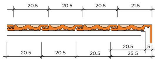
➔ Vous relèverez les spécifications concernant l'espacement des lattes, la largeur de couverture et la pente de toit ainsi que les dispositions de garantie sur l'annexe **«Couverture de tuiles en terre cuite - principes d'utilisation»**.
